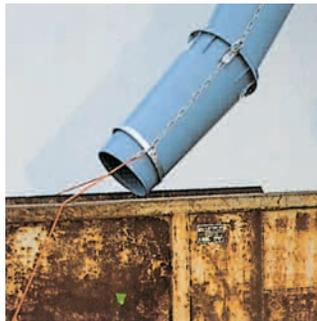
Das letzte Element wird mit dem Führungsring zum Container geführt und dort befestigt. Pos. 14
