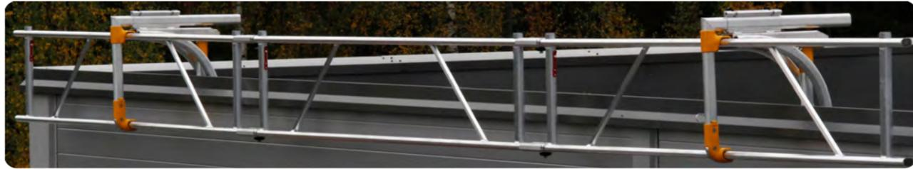
Die **AluFix®EVO**- Attika-Brücke dient als Erweiterung zur temporären Absturzsicherung mit Gegengewichten für sicheres Arbeiten auf Ebenen bis 10° Neigung mit Attika. Es erfüllt die Anforderungen der Norm EN 13374-A und ist mit dem GS-Zeichen für geprüfte Sicherheit ausgestattet.
